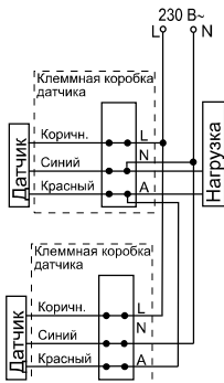
Рисунок 19 – Схема параллельного подключения датчиков
