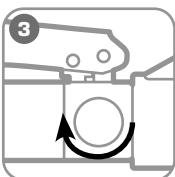
**Поверните винт сброса давления в положение «Закрыть»**
