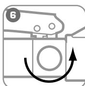
**Для сброса давления поверните винт сброса давления в положение «Открыть»**
